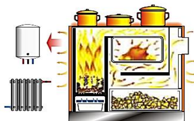
Vintereldning ⇒ Matlagning, bakning, tappvarmvatten och det centrala värmesystemet
