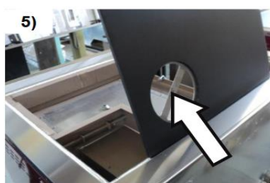
5) Skruva loss de fyra muttrarna och sen ta bort ringen
