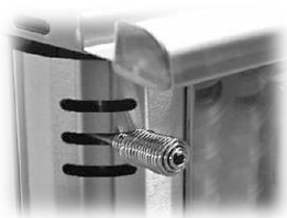
Stängt rökgasspjäll (17) När brasan har kommit gång ⇒ rökgaser berör konvektionsytor
