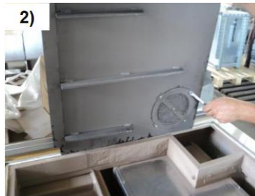
2) Lyft ner försiktigt den större topplattan och sen ta bort täcklocket vid skorstensanslutningen
