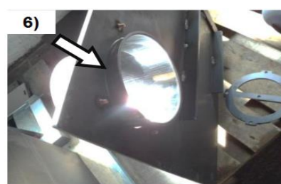
6) Lägg rökstosen i hålet
